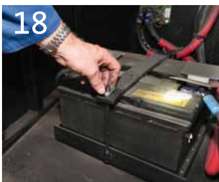
16 Kontrolle der Stärke der Bremsbeläge | 17 Untersuchung des Abgasverhaltens | 18 Überprüfung der Batteriebefestigung | 19 Messung der Scheinwerfer-Einstellung | 20 Alles sicher: Der Bus erhält die Plakette
