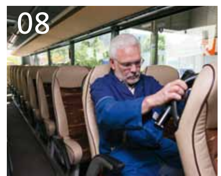
06 Überprüfung der Nothämmer | 07 Kontrolle der Beschilderung | 08 Überprüfung der Sitze und Sicherheitsgurte
