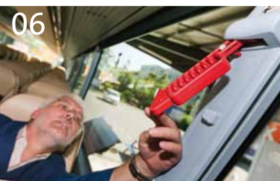
06 Überprüfung der Nothämmer | 07 Kontrolle der Beschilderung | 08 Überprüfung der Sitze und Sicherheitsgurte
