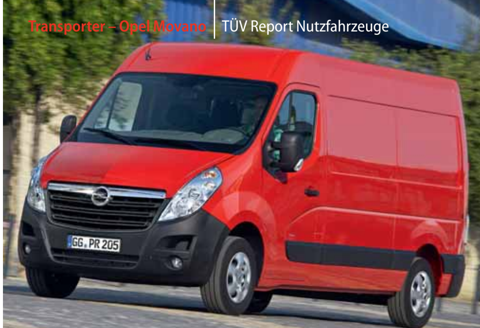
Während sich die Movano-Hinterachse als sehr solide erweist, liegt die Aufhängung der Vorderräder nach acht Jahren mit zwölf Prozent Mängelquote lediglich auf Klassenniveau
