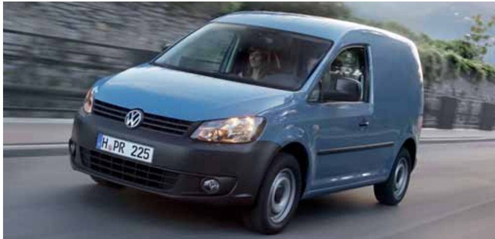
Den aktuellen Caddy gibt es in zwei Radständen. Darüber hinaus bietet VW den auf Touran/Golf-Plattform gefertigten Caddy als einzigen seiner Klasse auch mit Allradantrieb an
